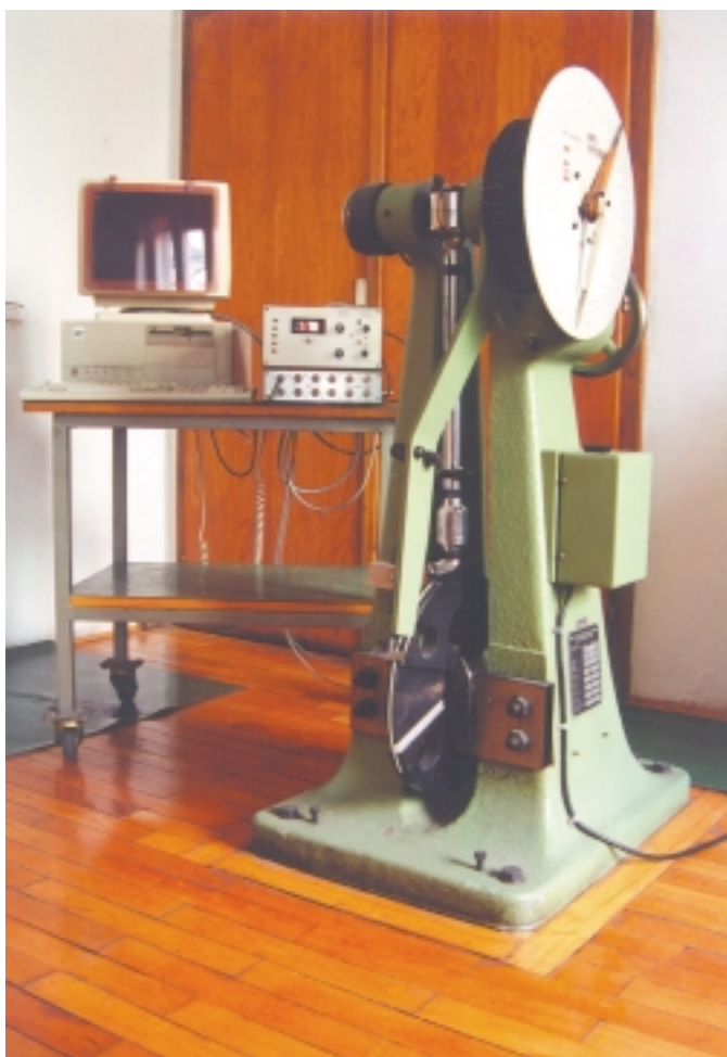
Instrumentirano Charpyjevo kladivo za merjenje udarne žilavosti na Inštitutu za kovinske materiale in tehnologije v Ljubljani
