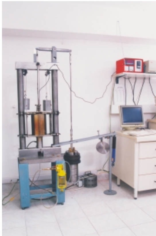
Preskusna naprava »small punch« za merjenje lezenja drobnih preizkušancev na Inštitutu za kovinske materiale in tehnologije v Ljubljani
