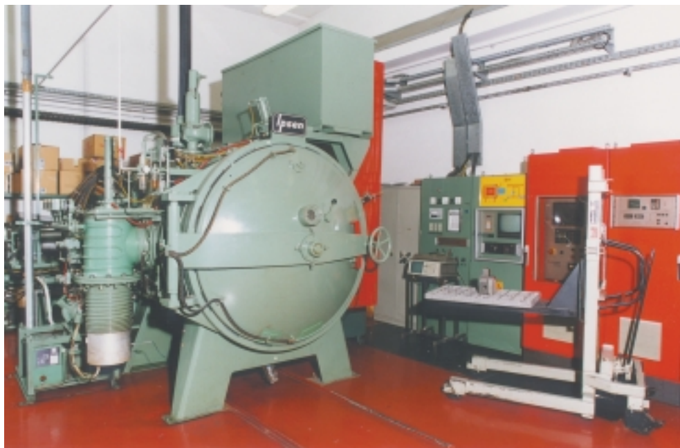
Vakuumska peč za toplotno obdelavo na Inštitutu za kovinske materiale in tehnologije v Ljubljani
