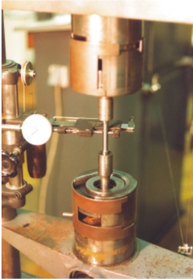
Merjenje kontrakcije na mestu pretrga cilindričnega preizkušanca z napravo Strictionmax
