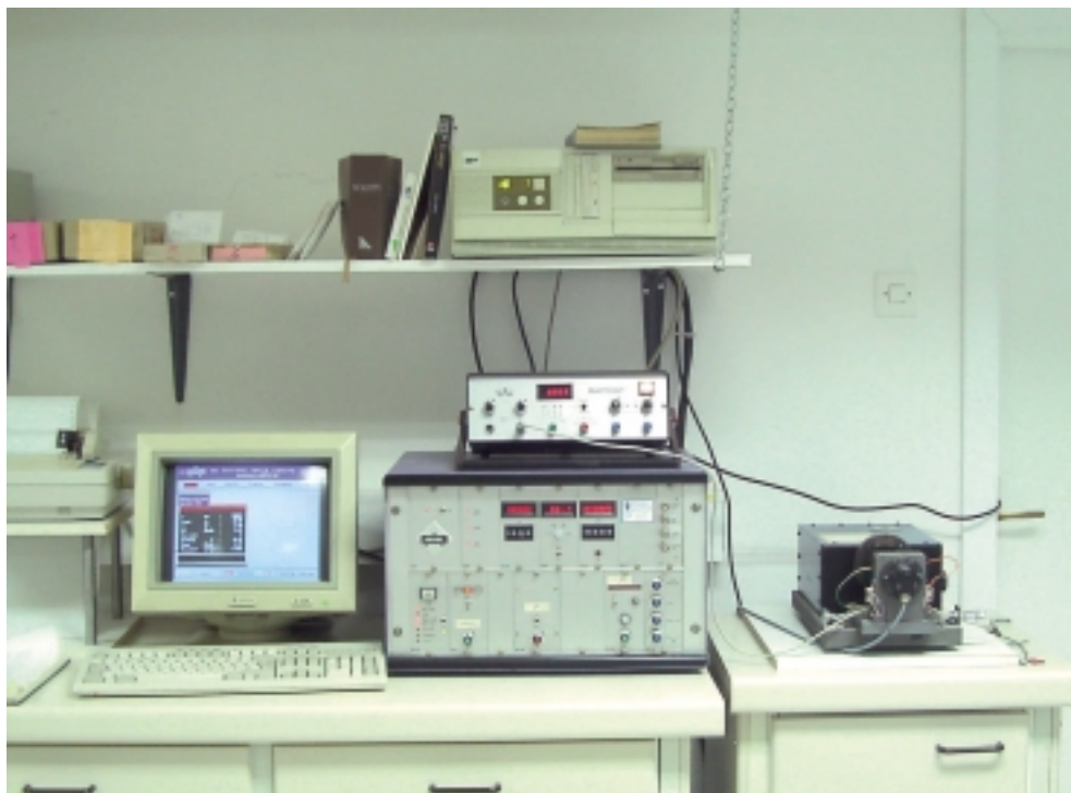
Resonantni pulzator za merjenje hitrosti napredovanja utrujenostnih razpok na Inštitutu za kovinske materiale in tehnologije v Ljubljani
