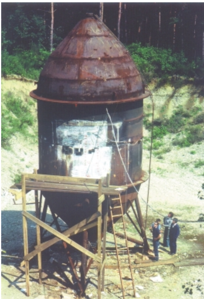
Lomnomehanski preizkus tlačne posode v naravni velikosti (prototip tlačnega cevovoda premera 4,2 m in debeline 47 mm, izdelan iz visokotrdnega jekla SUMITEN 80) za elektrarno Bajina Bašta. Preizkus je bil opravljen v Metalni Maribor.
