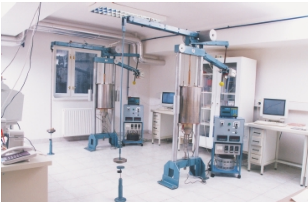
Napravi za merjenje lezenja pri konstantni obremenitvi na Inštitutu za kovinske materiale in tehnologije v Ljubljani
