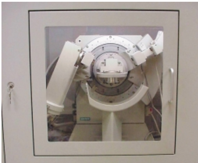
Rentgenski praškovni difraktometer za strukturno analizo (kristalne snovi) na Kemijskem inštitutu v Ljubljani
