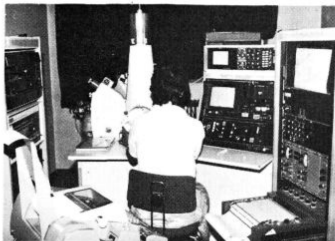
Pogled na vrstični elektronski mikroskop z napravo za elektronsko mikroanalizo in analizo slike
