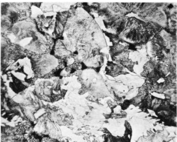
Slika 18 Mikrostruktura gredice 135 x 135 mm, točka 3; povečava x 100
