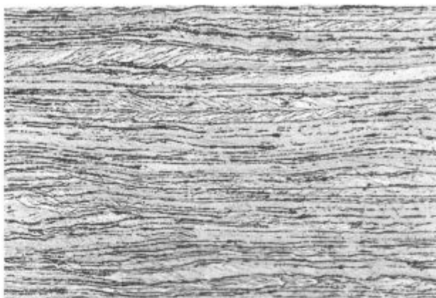
Slika 2 Pov. 200 ×. Hladno valjan trak 9134 N
