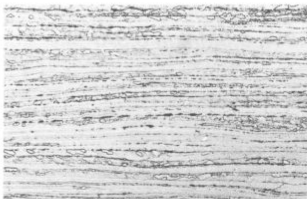
Slika 3 Pov. 200 × . Trak 4495 N, žarjen 5 min. pri 650 °C Fig. 3 Magn. 200 × . Strip 4495 N, annealed 5 min. at 650 °C
