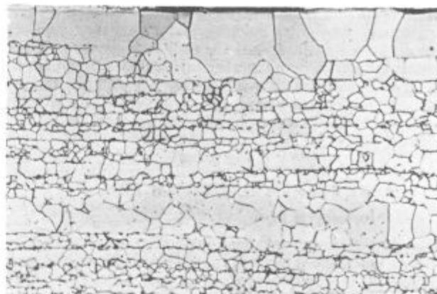
Slika 19 Pov. 200 ×. Trak 4503 G, žarjen 3 min. pri 900 °C
