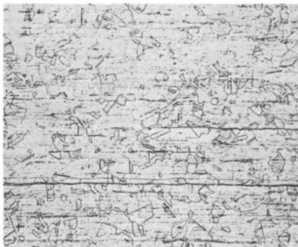
Slika 1: Avstinitna struktura s trakovi ferita — 100 ×
