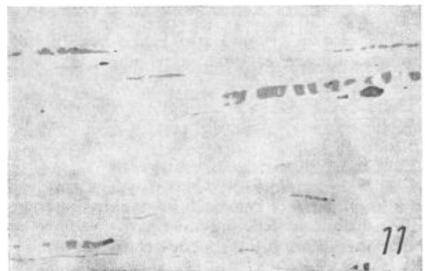
Slika 11 Jeklo ATJ 40 Q, pov. 200 ×; porušeni delci manganovega sulfida, pojav deformacijske modifikacije.
