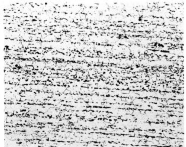
Slika 8 Struktura z veliko količino perlita — 100 ×
