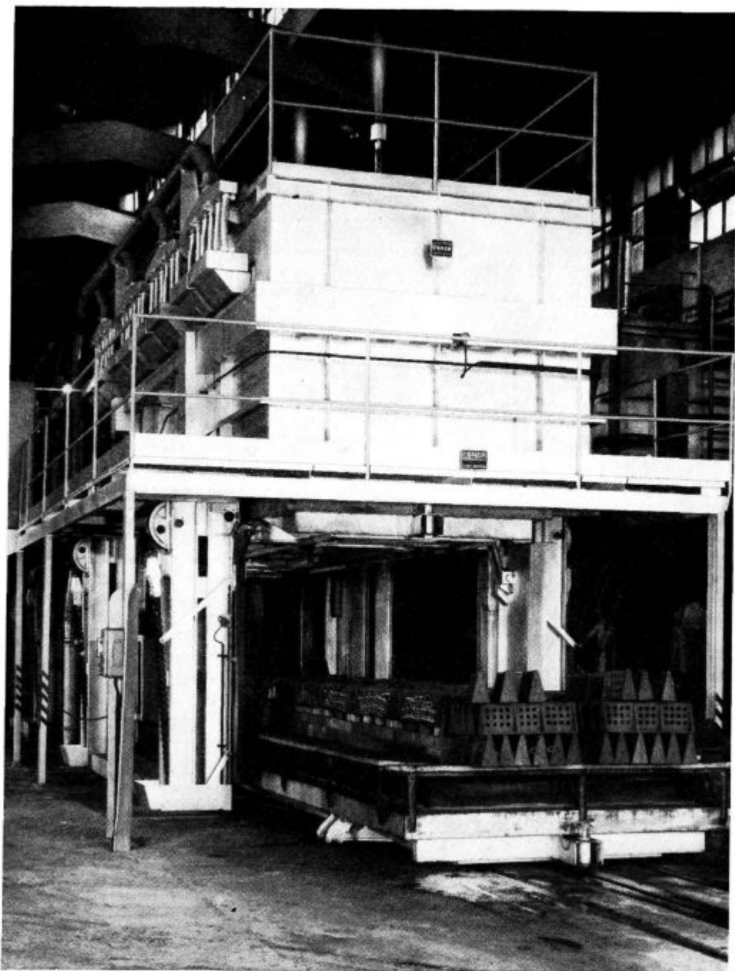
Elevatorska peč za proizvodnjo temprane litine; notranje mere: 1.900/1.350/7.400 mm, priključna moč 600 kw, max. temp. obratovanja 1.050° C. max. teža šar že: 15 t
