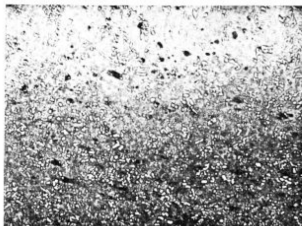
Slika 29 Primer razogljicene plasti orodnega jekla C. 4150 - OCR 12.
