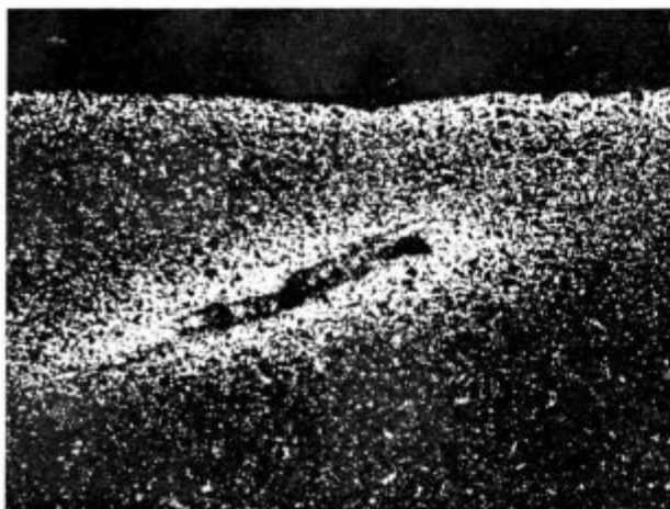
Slika 36 Razogljivenje v zvezi z napakami pri vroči predelavi jekla (C. 4830).
