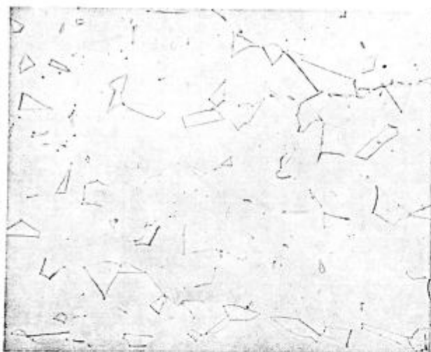
Slika 10 ( \times 500 ) lito stanje — ohlajeno v kokili
