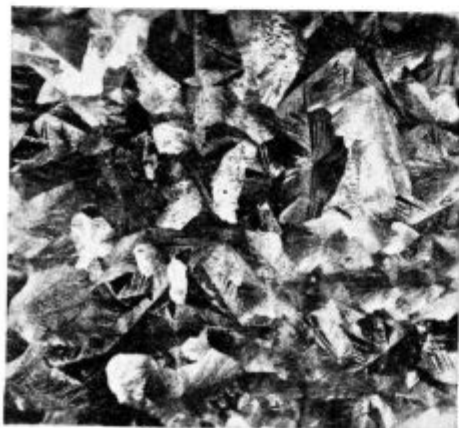
Slika 10 Ohlajevanje na mirujočem zraku
