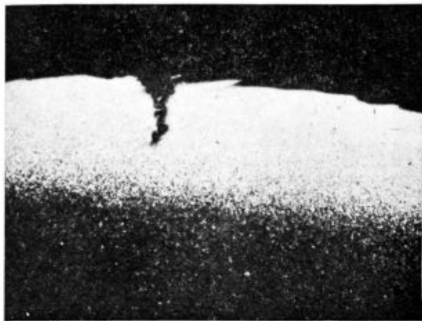
Slika 35 Razpoka v razogljiveni plasti jekla C. 4732 nastala zaradi termičnih napetosti pri kaljenju.
