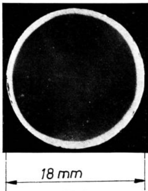
Slika 4 Razogljčena valjana palica Ø 18 mm orodnega jekla OC 100. Makrojedkan metalografski obris.
