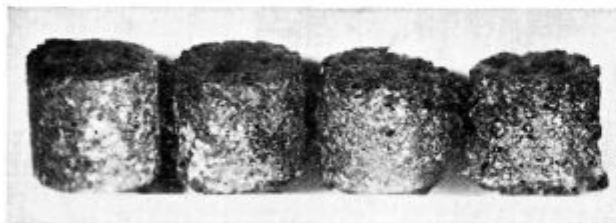
1 × 3 × 5 × 7 × Večkratno žilindranje korundnih vzorcev Slika št. 2
