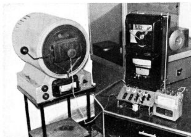
Slika 6 Laboratorijska programska žarilna peč
