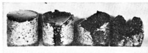
1 × 3 × 5 × 7 × Večkratno žilindranje šamotnih vzorcev Slika št. 3
