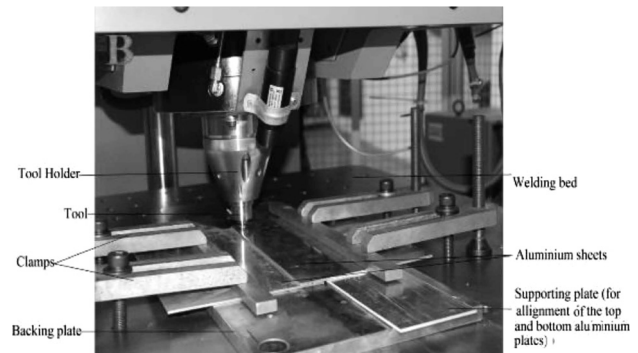
Figure 3: Experimental weld setup of FSW platform Slika 3: Eksperimentalna postavitev FSW platforme za varjenje
