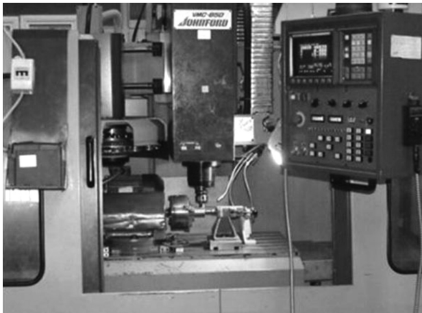
Figure 3: Tangential cylindrical grinding set-up mechanism Slika 3: Postavitev mehanizma tangencialnega cilindričnega brušenja
