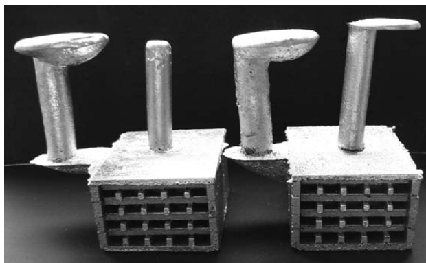
Figure 10: AlSiMg alloy castings with a regular cellular structure Slika 10: Ulitki iz zlitine AlSiMg z enakomerno celično zgradbo
