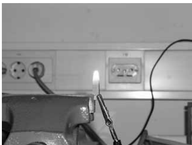
Slika 5: Delovanje prototipne keramične žarilne svečke, izdelane na našem odseku
