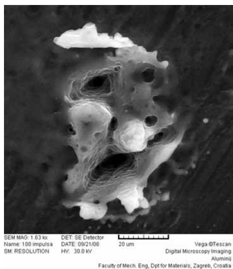
Figure 5: The target after 100 pulses (central part of damage) (SEM) Slika 5: Tarča po stotih impulsih (najbolj poškodovano območje) (SEM)
