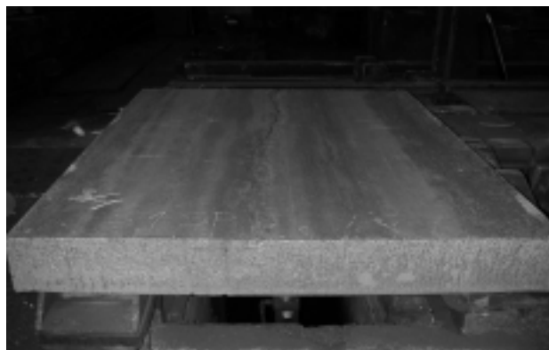
Slika 3: Vzdolžna razpoka na slabu Acroni 19 Si Figure 3: Longitudinal crack on the Acroni 19 Si steel slab surface
