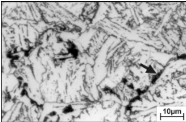
Slika 9: MA-mikrostrukturne sestavine v MK GZ TVP po popuščanju zaradi toplotnih ciklov naslednjih varkov
