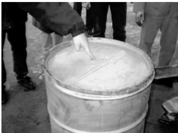
Slika 1: Poškodbe površine lahkega sode po preizkusu prebojnosti z višine 1 m
