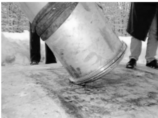
Slika 2: Padec težkega sode na rob privijačenega pokrova
