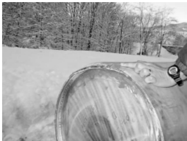
Slika 3: Poškodba lahkega sode pri padcu na rob v področju vzdolžnega zvara
