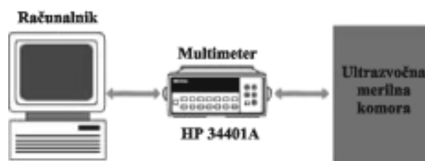
Slika 2: Blokova shema merilnega sistema, narejenega iz sestavnih delov COTS
