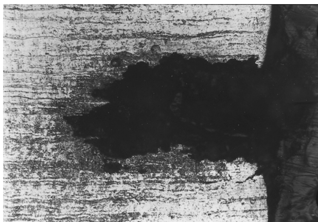
Slika 6: Metallografski posnetek prečnega prereza čez značilno razpoko pri toplotno neobdelanem nerjavnem jeklu (povečava 100-krat)
