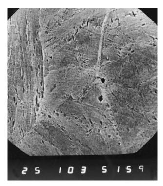
Figure 3: Blowholes on the section of solidified CC bloom Slika 3: Mehurčki na preseku strjenega kontinuirno ulitega bluma
