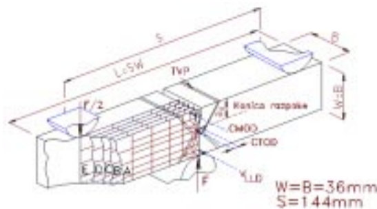
Slika 2: Modeliranje upogibnega lomnomehanskega preizkušanca z modificiranimi mrežami končnih elementov skozi debelino
