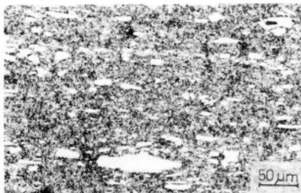
Slika 1: Mikrostruktura orodnega jekla OCR 12, jedkano z nitalom, 200 x
