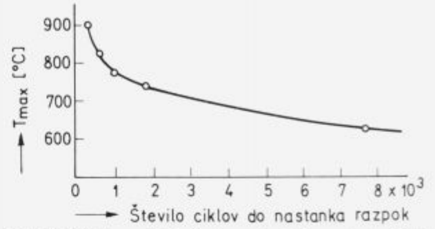
Slika 9. Začetek razpok (število temperaturnih krogov) pri različnih najvišjih temperaturah kroga za jeklo A.
