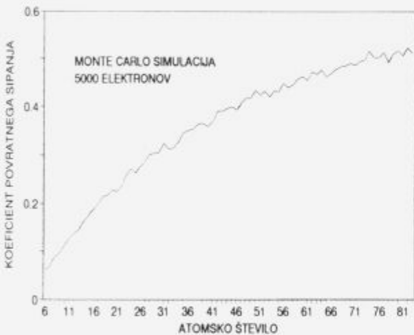
Slika 5. Odvisnost koeficienta povratnega sipanja od atomskega števila vzorca pri 20 keV.
