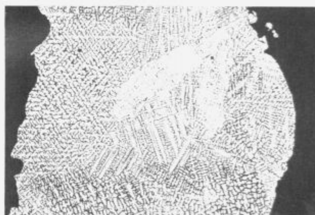
Slika 2. Dendritna strjevalna struktura v zrnih > 1400 \mu\text{m} .
