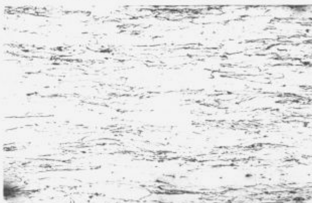
Slika 1. Mikrostruktura hladno valjanega, nelegiranega jekla, povečava 200×.
