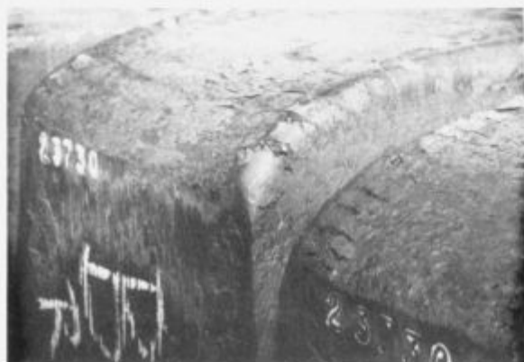
Slika 1. Površinske razpoke na liti gredici.
