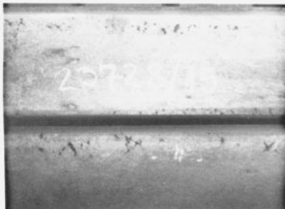
Slika 2. Površinske napake na gredici izvaljani iz lite gredice.
