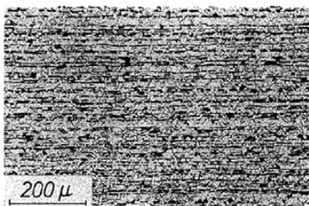
Figure 9. — Acier du type C. Microstructure à l'état laminé. Quantité d'inclusions : 7,1 mm/mm 2 de surface de la coupe longitudinale du feuillard.
