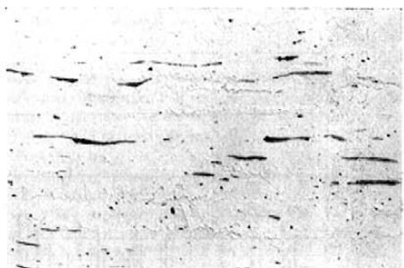
Figures 14, 15 et 16. — Inclusions de sulfure dans les aciers U, C et S. Attaque légère au nital. × 100
