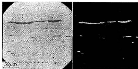
Slika 10 Vključki manganovega sulfida na vzdolžnem prereku jekla za avtomate. Analize, katerih rezultati so na slikah 11 in 12, so bile izvršene na jeklih s podobnimi vključki
