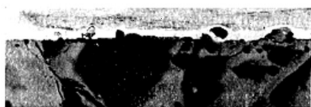
Fig. 1. — Oxydation à 800°C.
